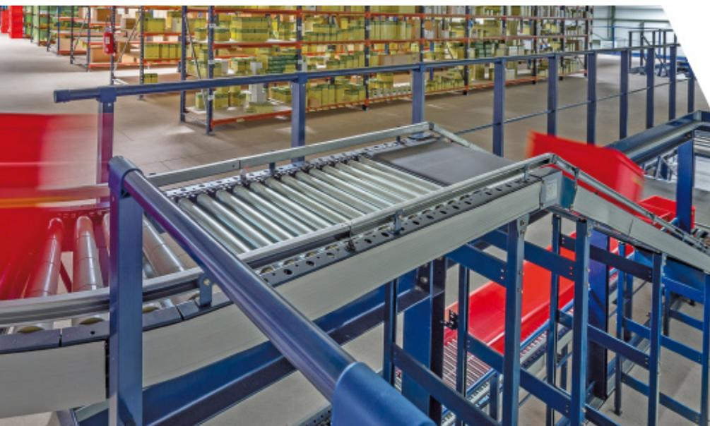
Les convoyeurs à bandes permettent de neutraliser les effets des dénivelés et de monter vers les différents niveaux, alors que les convoyeurs relevables facilitent le passage des opérateurs
