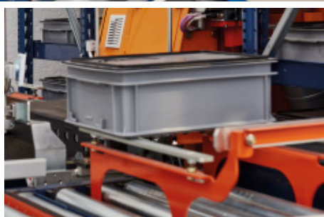
Les convoyeurs à rouleaux avec levage se trouvent dans la zone périphérique du magasin pour récupérer ou amener les caisses au transstockeur.
